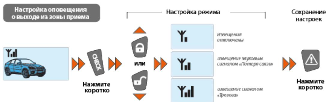
Заводская настройка извещения о выходе из зоны приема - отключено.
