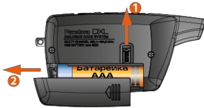
вибрировач. Для замены элемента питания: • Сдвиньте фиксатор крышки батарейного отсека в направлении, указанном стрелкой 1; • Сдвиньте крышку батарейного отсека в направлении, указанном стрелкой 2; • Извлеките элемент питания из батарейного отсека и установите новый; • Брелок готов к работе (включите его нажатием кнопки в течение 3 секунд). **Рекомендуем иметь в автомобиле запасную батарейку AAA.**
