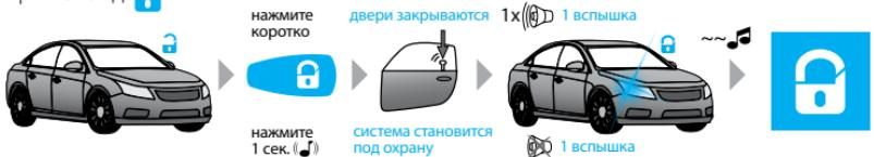
Для постановки на охрану без звукового подтверждения нажмите кнопку
